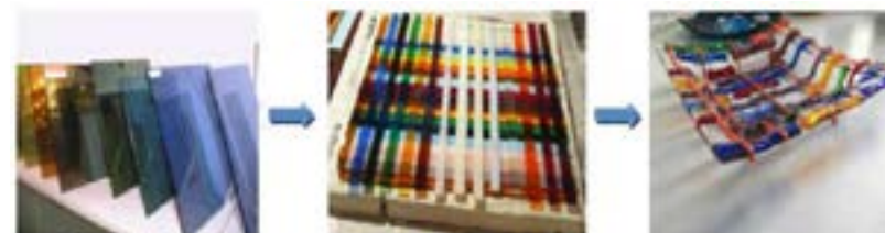
Рисунок 3 – Технологический процесс производства бытовых изделий на керамических формах
